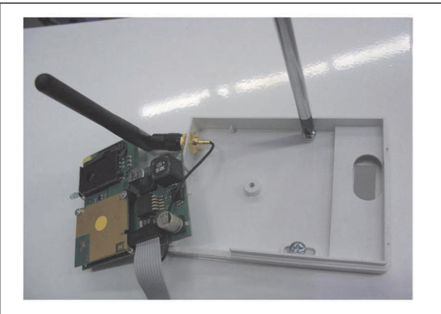
Plastovou krabičku přišroubujte dvěma šrouby do připravených otvorů v krytu kotla. Krabička musí být otočena tak, aby LED dioda po smontování směřovala k obsluze. Namontujte zpět elektroniku do krabičky opačným postupem.
